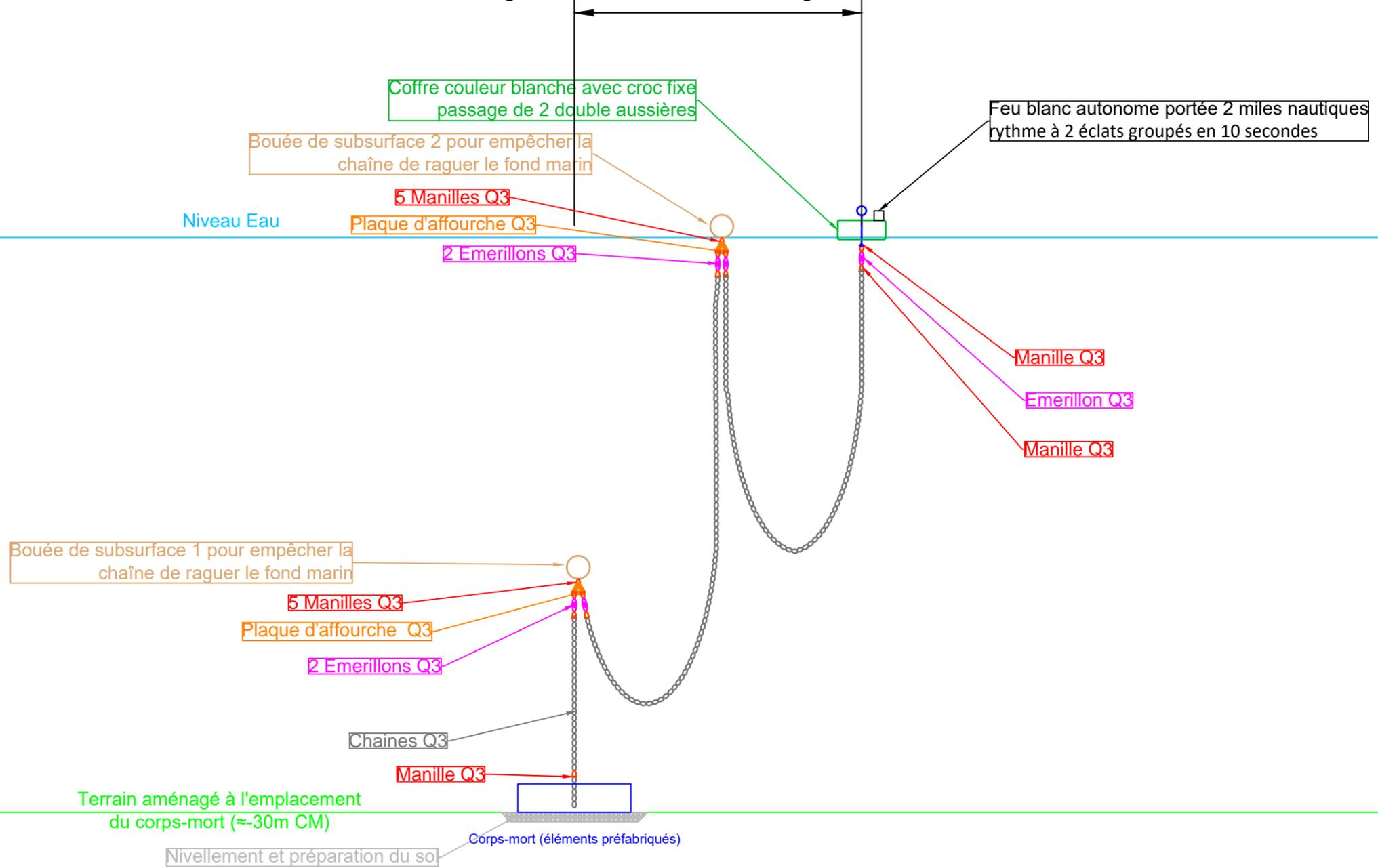
Coupe type d'un mouillage à l'évitage avec 2 bouées de subsurface
