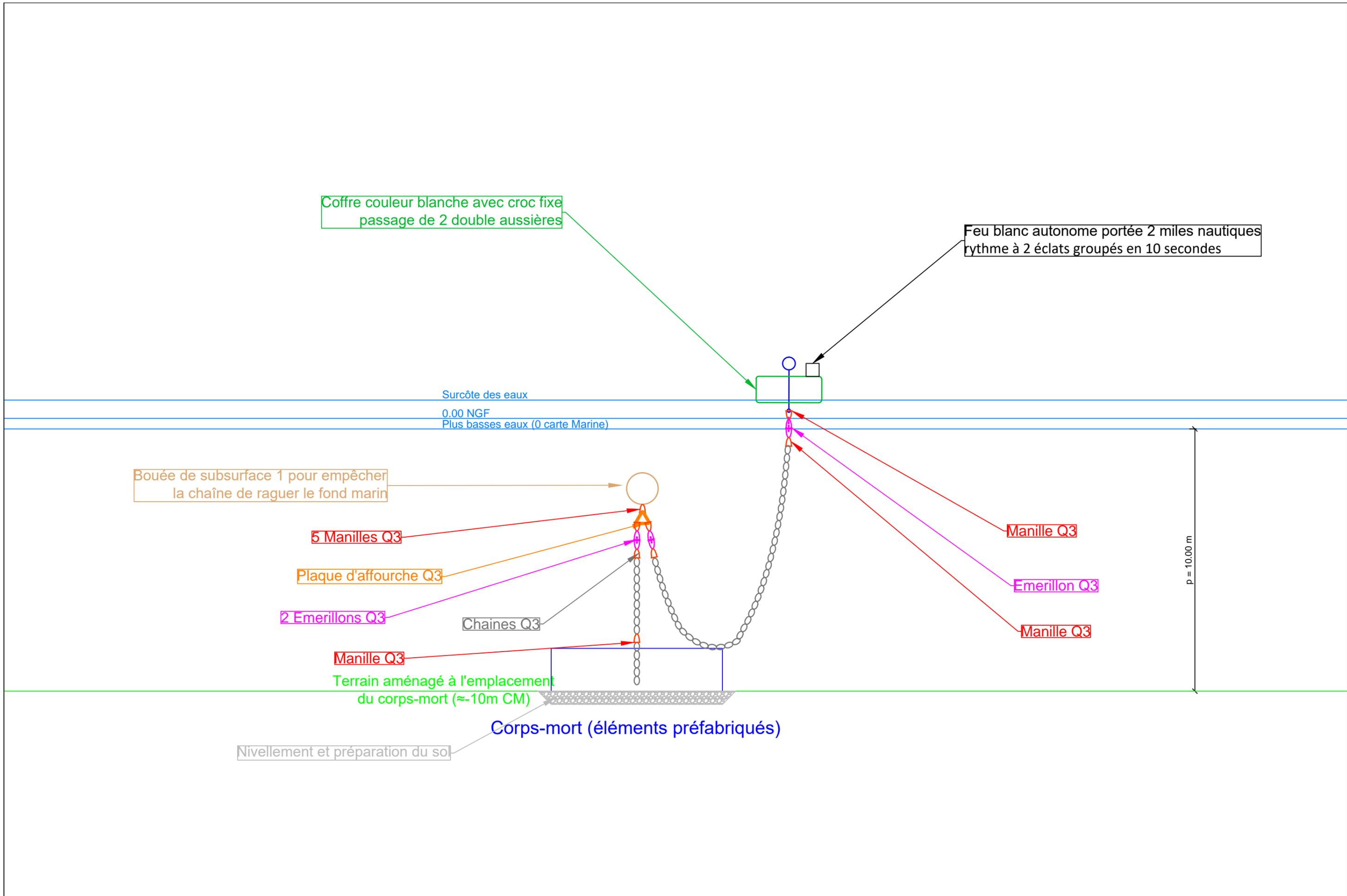
**Coupe type d'un mouillage à l'évitage avec 1 seule bouée de subsurface**
