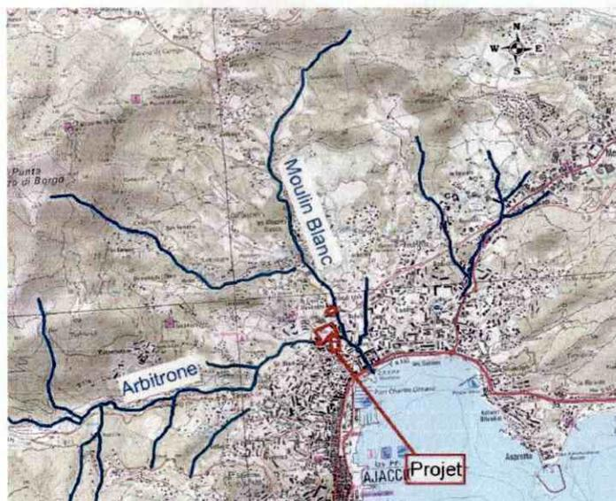
Le projet d'ouvrage de rétention est localisé dans la partie basse du bassin versant de l'Arbitrone, entre la route d'Alata et la Rocade, sur le secteur des Padules. Il a été identifié pour la création d'un bassin paysager qui permettra de stocker un volume d'environ 40 000 m<sup>3</sup>. Cet ouvrage permettra d'écarter les crues de période de retour inférieure à 25 ans et d'améliorer le cadre de vie par la création d'un parc urbain sur l'emprise du bassin.
