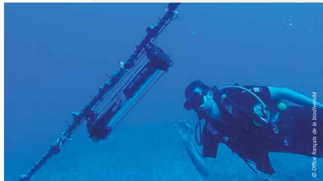
Pose d'un hydrophone lors de la phase test en 2019 à Saint-Barthélemy.
